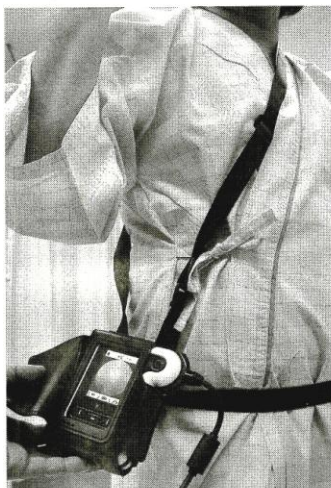
下腹部などに張られたアンテナから、カプセル内視鏡が撮影したデータを記録する「データレコーダー」
