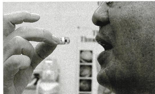
直径1.1㍉、長さ3.1㍉の大腸カプセル内視鏡。これを少量の水で「飲むだけ」だ
